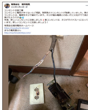
発熱発火でコンセントが破損した事例 お客様の了承を得て、フェイスブックやホームページに掲載されています。
